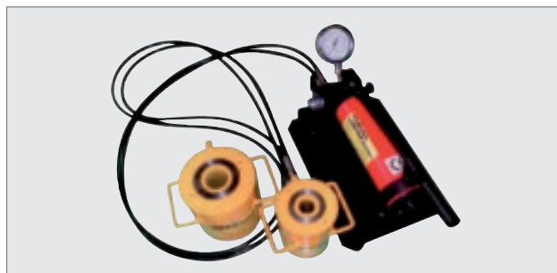
Attrezzatura per prove di trazione Tensile testing equipment
